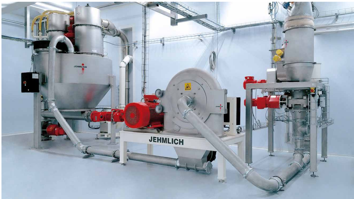
Abb.: Rekord-Zuckermahlanlage mit integriertem Puderzuckerbehälter inklusive Rührwerk
